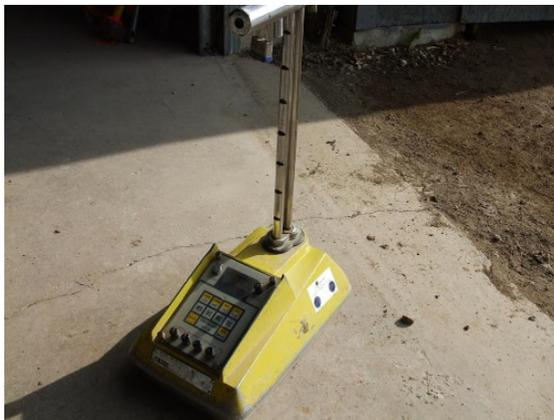
Рис. 2. Плотномер асфальта Troxler 2701-B
