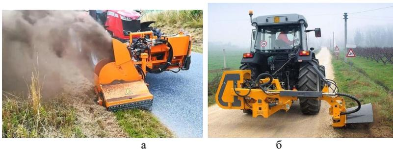
Рис. 2. Фрезеровщик дорожных обочин: а – фреза BF 600;
