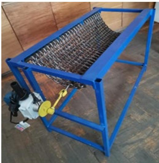
Рис. 2. Опытный образец волнового цепного грохота
