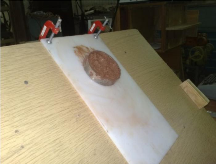
Рис.1. Стенд для определения угла трения
