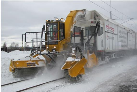
Рис.2 Снеготаятельная машина SR 700
