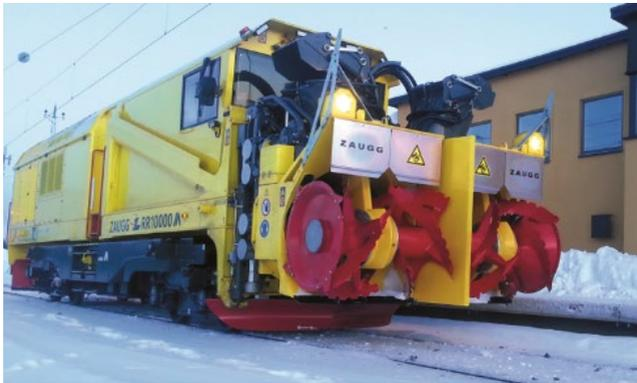
Рис.1 Снегоуборочная машина ZRR10000M
