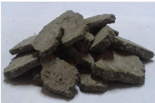
Рис.2 Клинкер после измельчения в ПВИ
