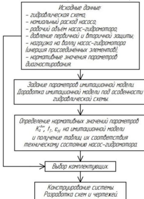
Рис. 1. Блок-схема алгоритма проектирования бортовой системы диагностирования гидропривода вращательного действия
