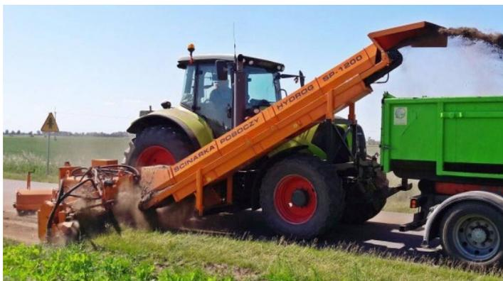
Рис 1. Фрезеровщик дорожных обочин HYDROG SP-1200
