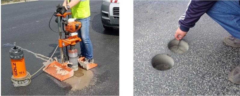
Рис. 3. Процесс изъятия образцов (керны) с помощью буровой установки
