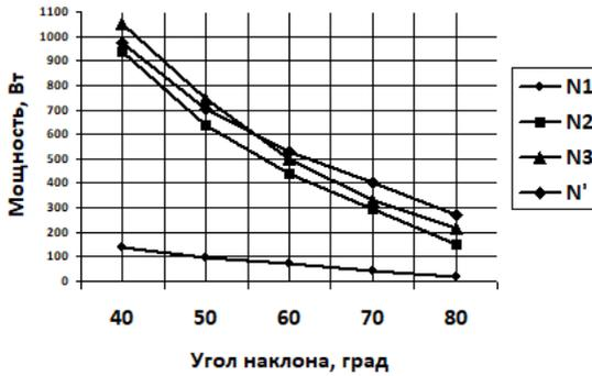
Рис. 6. Зависимость дополнительно потребляемой мощности от угла наклона ЛДД и ЛЭС к оси барабана мельницы
