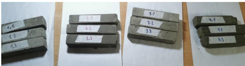
Рис. 4. Испытуемые образцы слева направо – без добавки, с добавлением Sika ViscoCrete-602, Sika ViscoCrete-3020 и Sika ViscoCrete-226
