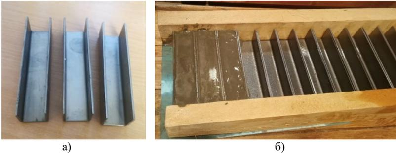
Рис. 2. Формы для образцов и их заполнение бетонной смесью:
