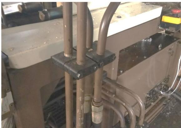
Рис. 2. Детали крепежные для крепления трубопроводов литейной машины
