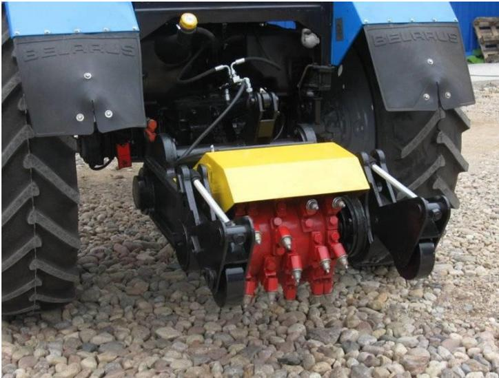
Рис.1. Навесное фрезерное оборудование к пневмоколесному трактору
