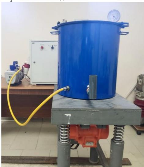
Рис. 2. Лабораторная установка для реализации технологического процесса заполнения оболочковых форм металлополимером
