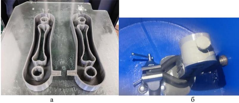
Рис. 3. а -отпечатанные полумодели детали «Серьга»; б – процесс заполнения пустотелой оболочки жидким металлополимером
