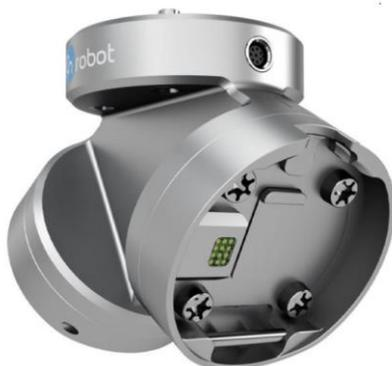
Рис. 1. Устройство OnRobot Dual Quick Changer
