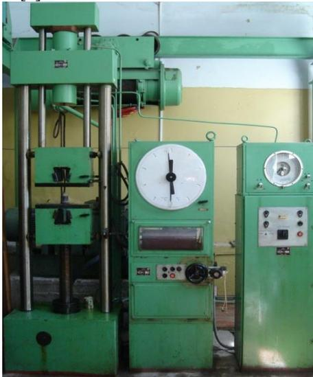
Рис. 1. Разрывная машина P20
