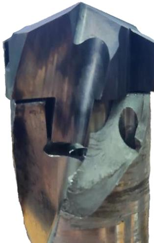
Рис. 5. Изображение места скола рабочей части корпусного сверла.
