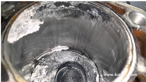
Рис. 1.5. Рабочая поверхность гильзы блока цилиндров после перегрева
