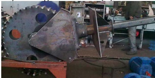
Рис. 4. крепление натяжного барабана к подвижной части механизма
