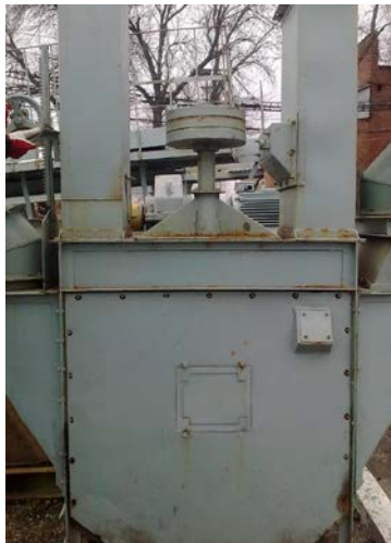
Рис. 3 -установка грузового натяжного устройства на башмаку
