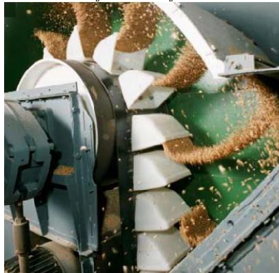
Рис. 4. разгрузка зернового материала из ковшей при центробежном режиме
