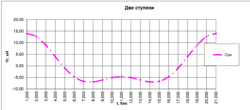
Рис. 2. График изменения центробежной силы виброплиты с бигармоническим колебаниями. Y_r – ось величины вынуждающей силы, t – время
