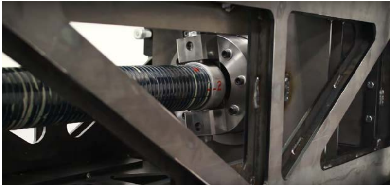
Рис. 2.11. Испытание приводного вала на циклические нагрузки
