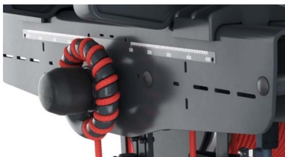
Рис. 3. Система фиксации конца синтетического каната, используемая на тельферах фирмы Konecranes [7]
