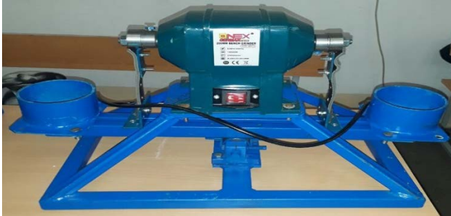
Рис. 2. Лабораторная установка балансирной вибрационной мельницы для сверхтонкого помола
