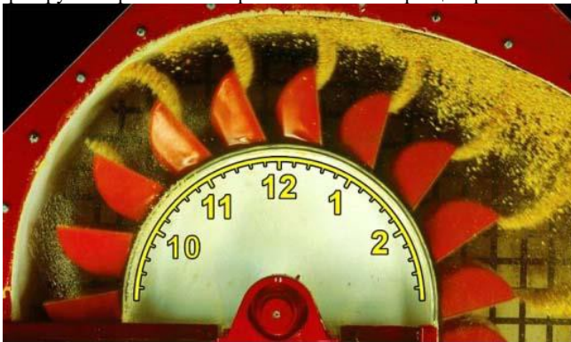
Рис. 5. траектории выбрасывания зернового материала при разных углах поворота барабана по условному циферблату
